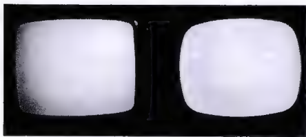
Links das Bildfenster der neuen Westinghouse-Flachschrilm-Röhre mit 58 cm Diagonale im Vergleich zu einer normalen 53-cm-Bildröhre (rechts)
